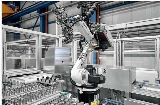
**Bild 2.** Ein Sechssachsroboter führt die Spritzteile der Kameraprüfung (hinterer Bereich) und der Selektierung zu und legt die Gutteile ab (vorderer Bereich) © Arburg
